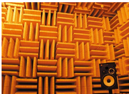
音波伝搬の基本的性質を測定可能な音場、無響室。
